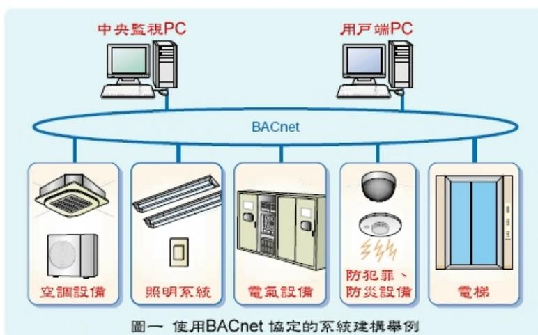
由於使用 BACnet 協定，使向來設備系統的製造商，不再需要對應單獨規格的個別介面，而可以讓諸如空調設備、照明系統、電器設備、防犯罪、防災設備等，以及電梯之類的各種相關產品的製造商，都可以介入共通介面，而得以建構完全進行連線溝通、溝通、監控之多元販售商對應系統。
